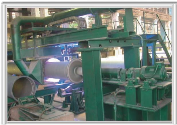
Снаружи трубы из высокопрочного чугуна покрывают цинковым и лаково-битумным покрытием, изнутри - цементно-песчаным. Такая система способна прослужить 100 лет без замены и не влияет на состояние транспортируемой жидкости, сводя на нет любое влияние окружающей среды, поскольку непроницаема для углеводородов и органических химикатов, находящихся в почве и грунтовых водах.
