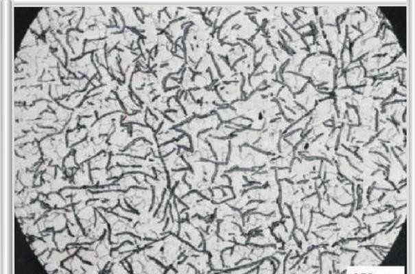
Металлография серого чугуна с пластинчатым графитом
